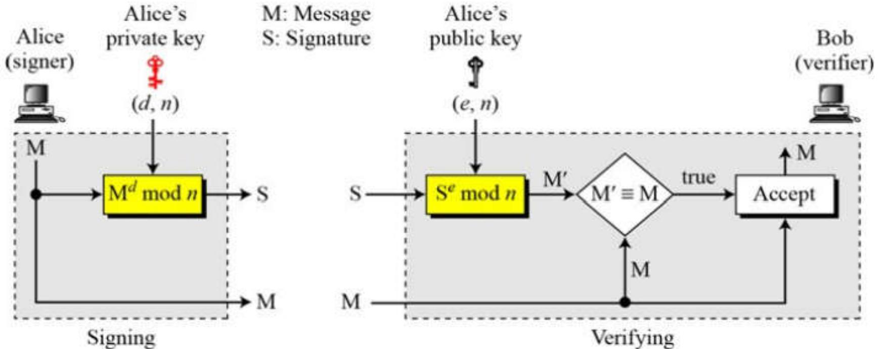
$$M' \equiv M \pmod{n} \quad \rightarrow \quad S^e \equiv M \pmod{n} \quad \rightarrow \quad M^{d \times e} \equiv M \pmod{n}$$
