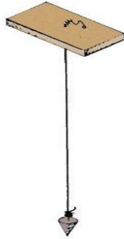
الشكل 8.2 الشاقول – ثقل مخروطي بطرف الخيط [2].
