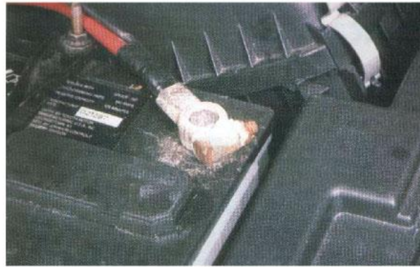
شكل (١ - ٢١): التآكل الكيميائي لأقطاب البطارية وأطراف توصيل الكيابل
