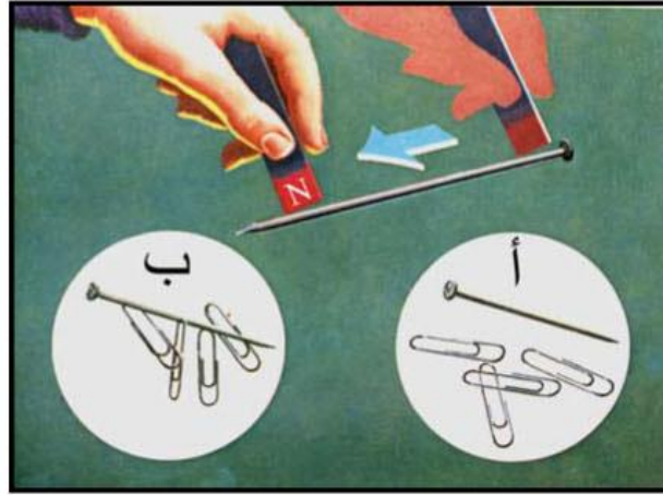
شكل (١ - ١٧) يوضح تحول المسمار إلى مغناطيس له قطبان شمالي (N) وجنوبي (S)
