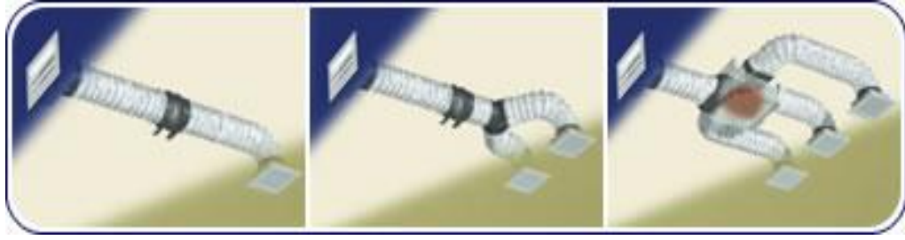
صور توضح شكل المجاري الهوائية (Grille) المصنوعة من الكرتون المقوى على شكل (أنابيب زنبركية).
