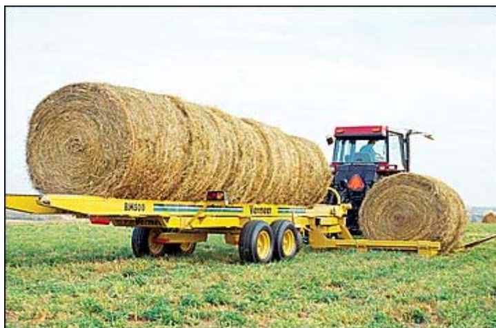
شكل (٥) مقطورة آلية لتحميل البالات الأسطوانية بشكل آلي
