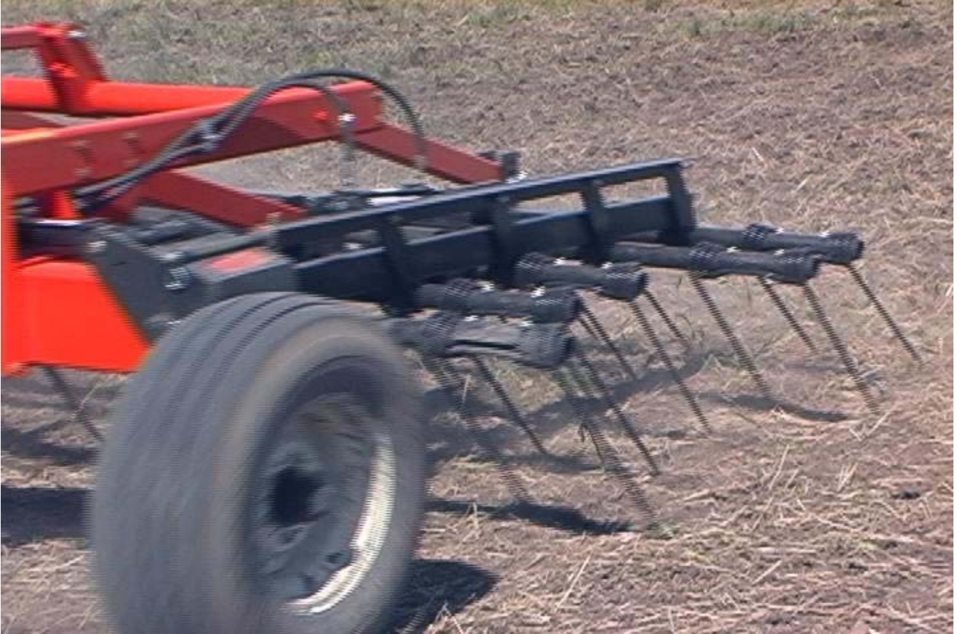
شكل (٣) مجمعات أعلاف مقطورة ذات أمشاط متوازية تدار هيدروليكيًا
