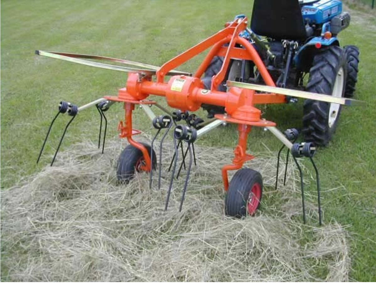
شكل (٢) آلة تجميع أعلاف تدار بالعمود الخلفي للجرار
