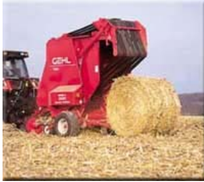
شكل رقم (٥). يوضح طريقة تفريغ البالة الدائرية
