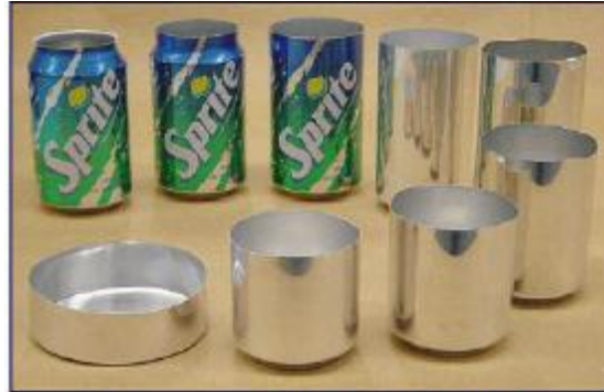
شكل (٣٦-٧) مراحل السحب العميق المتعددة لإنتاج لوعة الصودا
