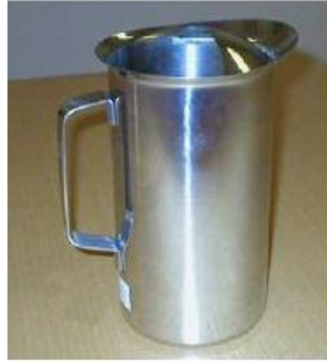
شكل (٣٨-٧) صورة لمنتج مصنوع بعملية السحب العميق
