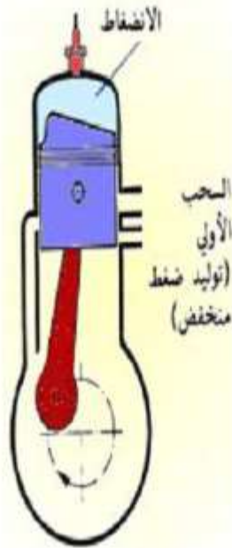
(الشكل 1 - 14) يوضح حركة الكباس من أسفل إلى أعلى ضاغطاً الخليط في حيز الانضغاط
