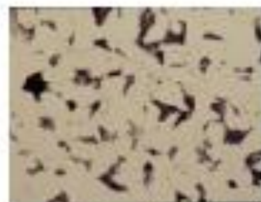
شكل (١٠-١) فولاذ بنسبة كربون ٠.٢% (ترقلة على الساخن) ويظهر الفريت (اللون الفاتح) و البرليت (اللون الداكن).
