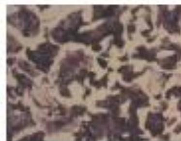
شكل (١٠-٣) فولاذ بنسبة كربون ٠.٤% ويظهر الفريت (اللون الفاتح) و البرليت (اللون الداكن).
