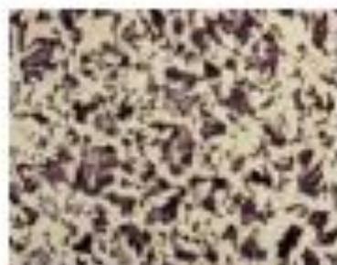
شكل (١٠-٢) فولاذ بنسبة كربون ٠.٣٦% (ترقلة على الساخن) ويظهر الفريت (اللون الفاتح) و البرليت (اللون الداكن).
