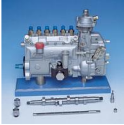
شكل (11.6) : مضخة الوقود على خط واحد وعمود الكامات الذي يشغل المضخات الصغيرة
