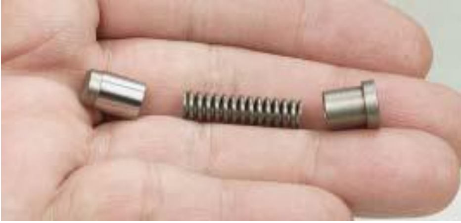
شكل (11. 31): صمام مانع موجات الوقود العكسية (بعد عملية رش الوقود)
