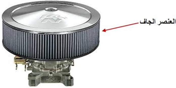
(10.4) منظم الهواء ذو العنصر الجاف الذي يستخدم في محركات البنزين
