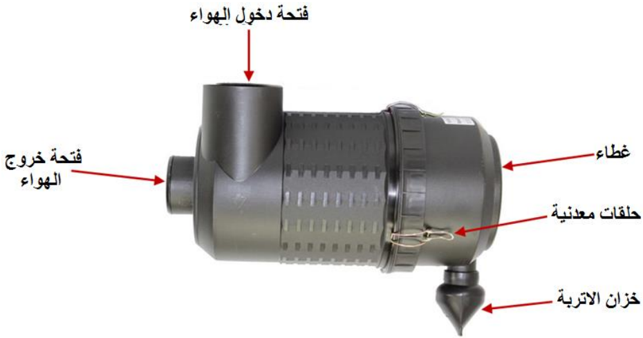
شكل (10.3) : منظف الهواء ذو العنصر الجاف المزود بغطاء يثبت بحلقات معدنية
