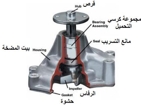
(b) : مقطع في مضخة الماء يوضح أجزائها المختلفة.
