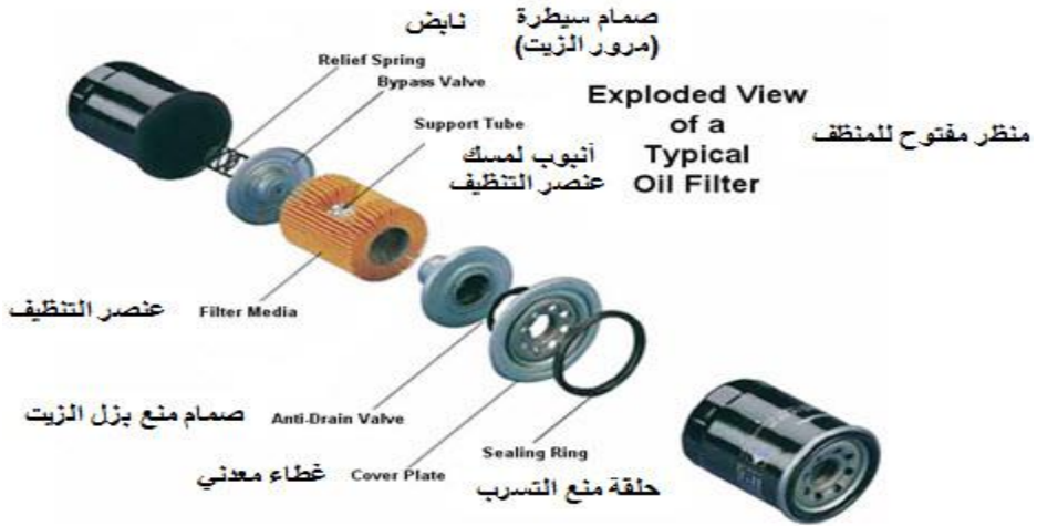
(b) : الأجزاء الكاملة لمصفي الزيت من النوع ذو الجريان التام
