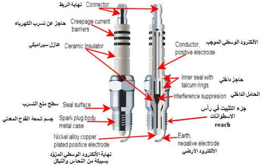
شكل (7.16): أجزاء شمعة القدح
