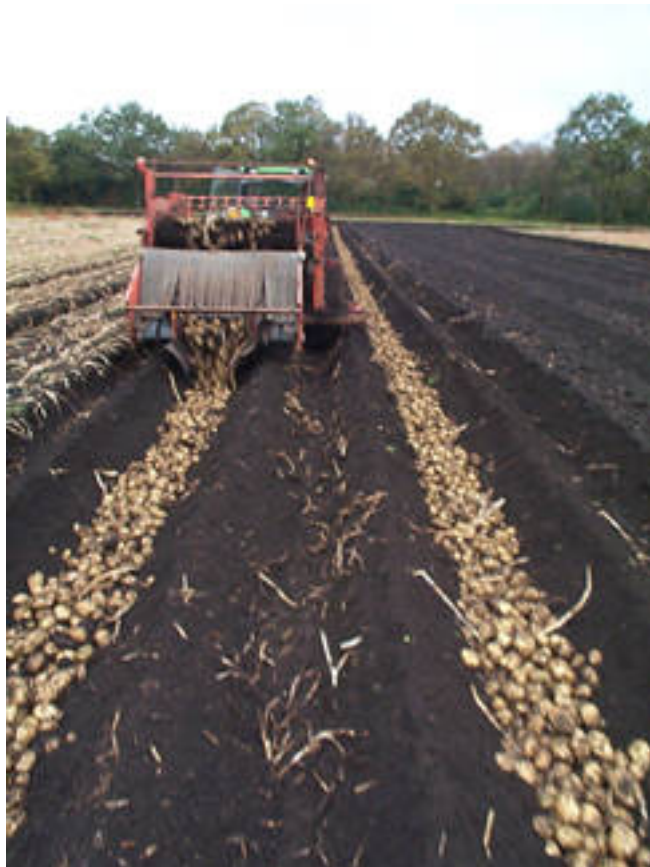
شكل (٣) سقوط الدرناات خلف الآلة
