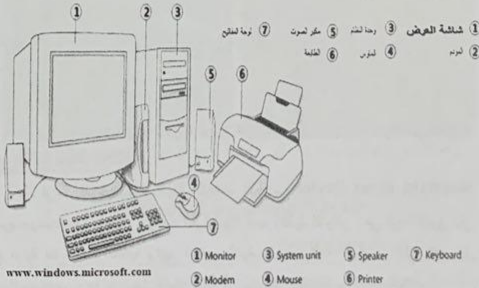
الشكل (1-2) يبين الأجزاء والملحقات الرئيسية للحاسوب المكتبي
