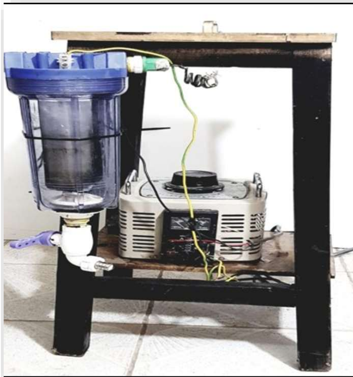
شكل (2): صورة فوتوغرافية لجهاز تصنيع الديس بالتسخين الأومي
