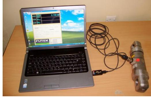
(A): جهاز خلية الحمل وهو موصول بجهاز الكمبيوتر.
