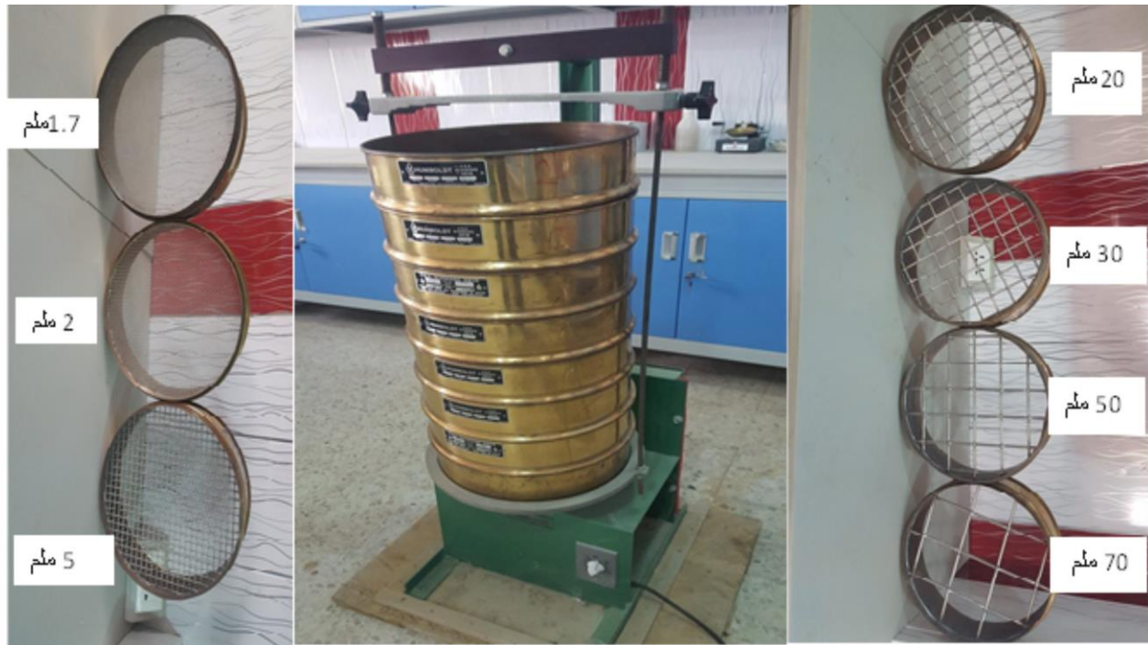
شكل (3): جهاز النخل والمناخل المستخدمه
