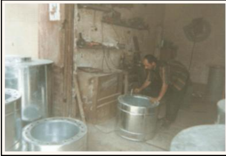
صورة (٣) انتاج التناير المعدنية وخزانات المياه وغيرها معتمدة على العمل اليدوي في حرفة التنكجية ، التقطت الصورة بتاريخ ٢٠٠٧/٨/٥
