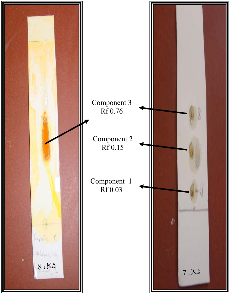
(الشكل 7) كروماتوغرافيا الطبقة الرقيقة للمستخلص القلويدي
